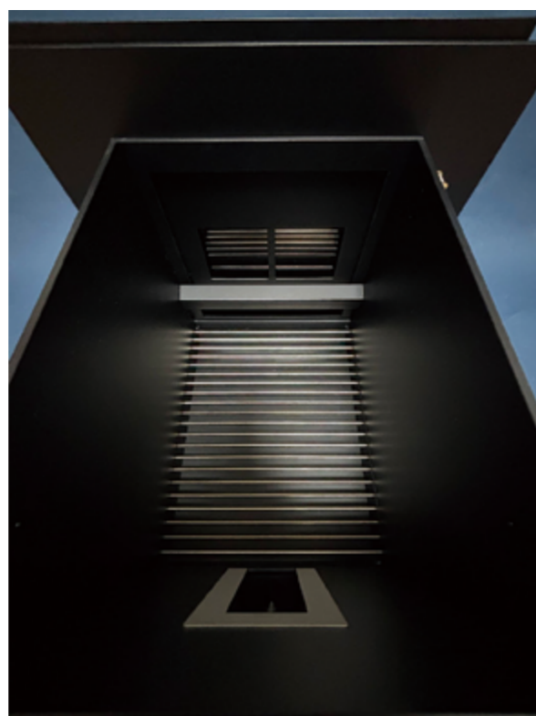
タッチパネルオペラント実験箱ラット Touch panel operant chamber for rat
