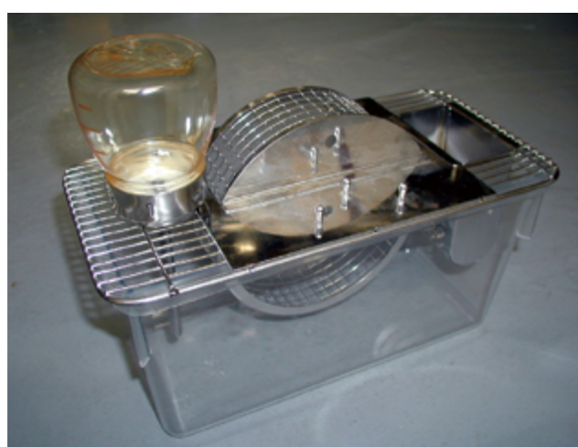
ホイール(回転かご)メーター <運動活性・活動量・リズム> Wheel meter <activity / amount of activity / biological rhythm> ※Multi chamber system (1 – 48 chamber)
