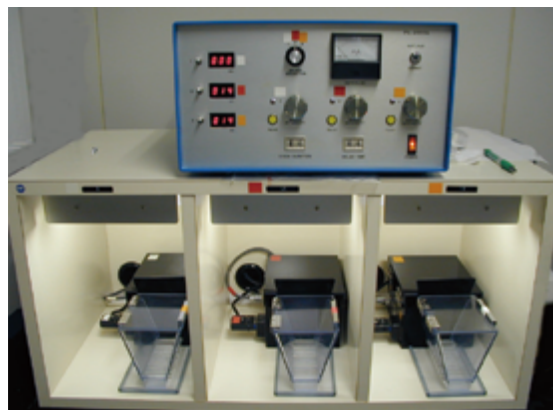
受動的回避反応実験装置 <文脈に対する回避条件付け> Passive avoidance test (Step-through type) <avoidance conditioning for contextual> ※Multi chamber system (1 – 20 chamber)
