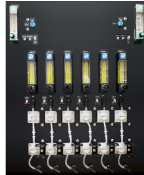
匂い刺激提示ユニット<学習記憶> Odor test unit <learning memory>
